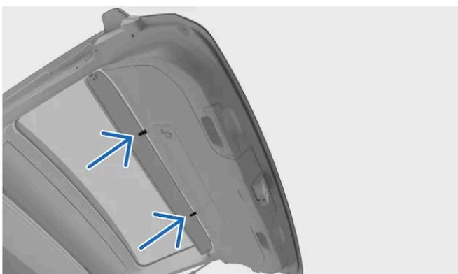
Spingi verso l'alto le due clip sul lato lungo della copertura del bagagliaio e falle scattare in posizione sul bagagliaio.
