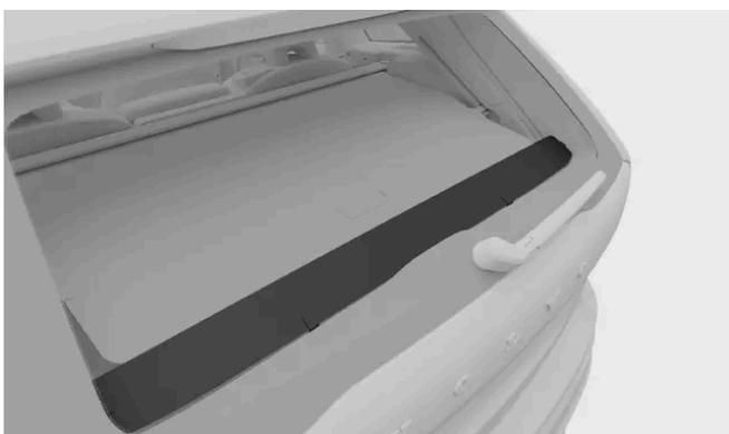
La copertura del bagagliaio è installata e copre il vano di carico del bagagliaio.
