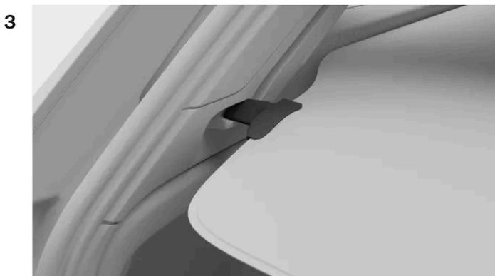
Guidare le estremità del pianale in posizione di blocco nelle scanalature.
