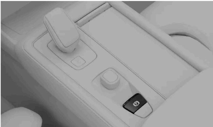
Innesta manualmente il freno di stazionamento tirando l'interruttore del freno di stazionamento.
