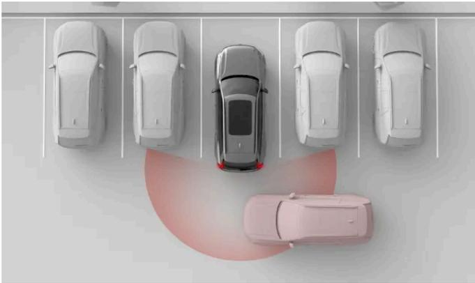
La tua auto è in grado di rilevare la presenza di un'auto dietro di te, ad esempio quando fai retromarcia per uscire da un parcheggio. Può avvisarti in modo che tu possa rallentare o frenare.
