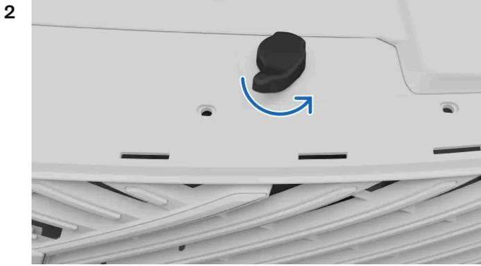
Individua la seconda leva sotto il bordo anteriore del cofano e ruotala in senso antiorario.
