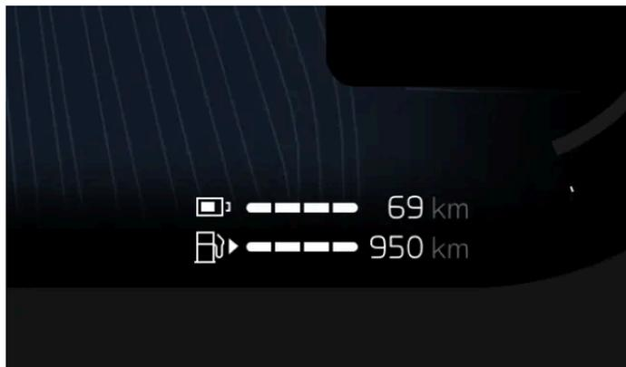
La tua autonomia dipende principalmente dalla batteria della tua auto, dalla quantità di carburante rimasto nel serbatoio della tua auto e dal tuo stile di guida, ma anche le condizioni esterne possono influire. Il livello della batteria e l'autonomia prevista sono visualizzati nel display del conducente. L'autonomia prevista viene calcolata in base al tuo stile di guida, attuale e storico.
