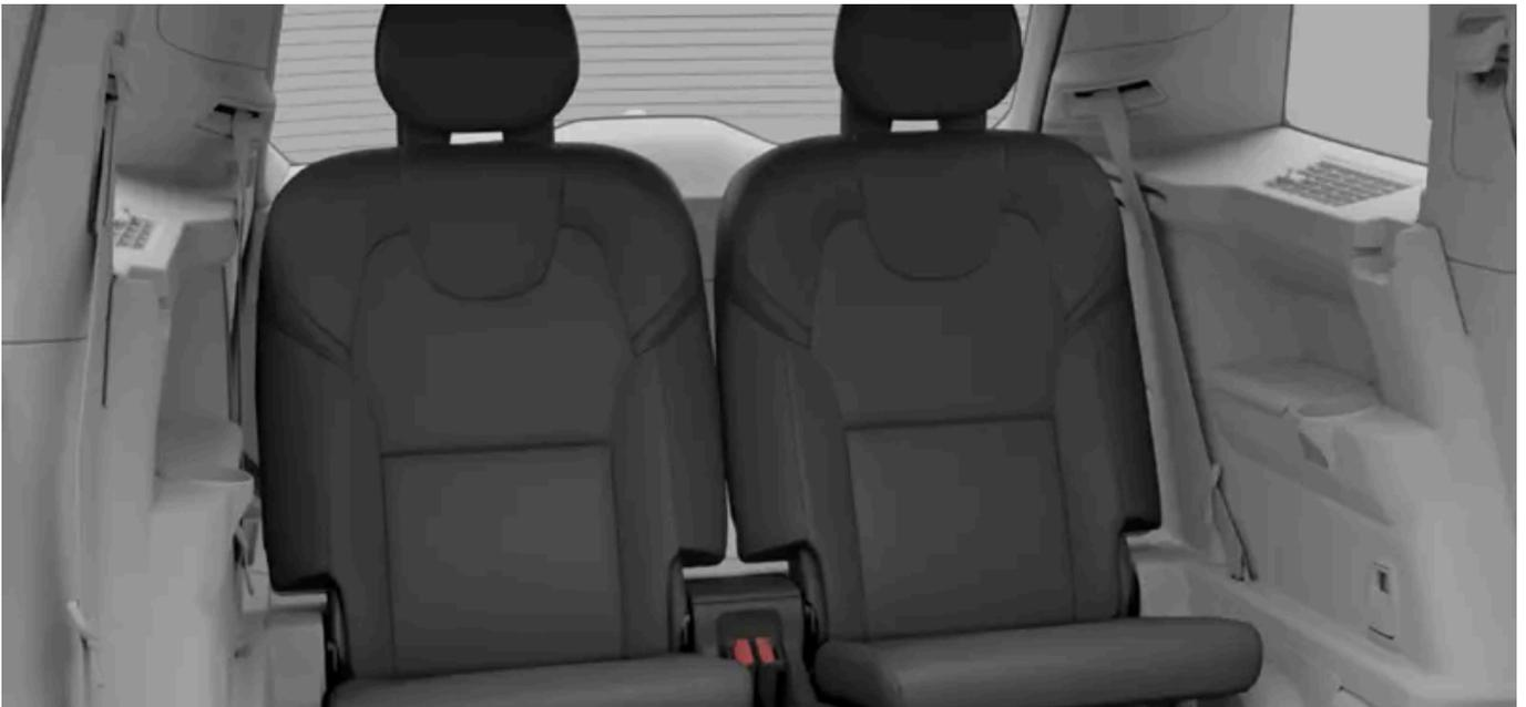
Gli schienali e i poggiatesta si possono chiudere in un unico movimento per ricavare più spazio. Il poggiatesta si abbassa automaticamente quando si abbassa lo schienale.
