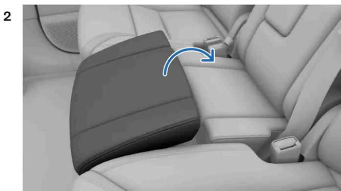
Con una mano sulla parte anteriore del seggiolino per bambini e una sulla parte posteriore, solleva il seggiolino e spingilo all'indietro fino allo schienale del sedile.
