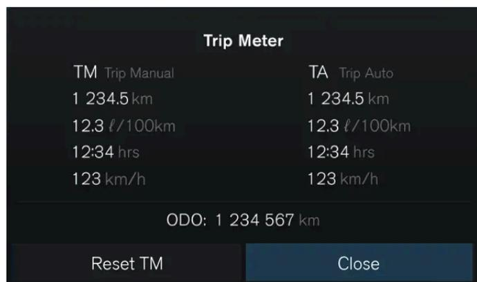
La tua auto è provvista di un contachilometri parziale e di un contachilometri. Il contachilometri parziale può mostrarti informazioni sulla distanza e sul tempo di guida della tua auto, oltre al consumo medio di carburante e alla velocità di guida.
