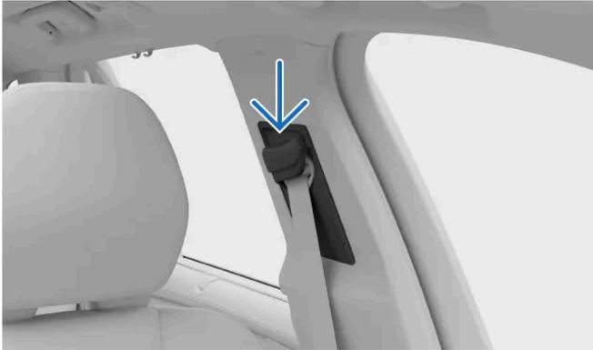
Punto di fissaggio superiore della cintura di sicurezza
