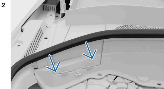
Il contenitore del liquido di raffreddamento si trova nell'angolo superiore sinistro del vano motore, sotto il portellone di un pannello. Tira la guarnizione di gomma verso il vano motore per accedere al portellone.
