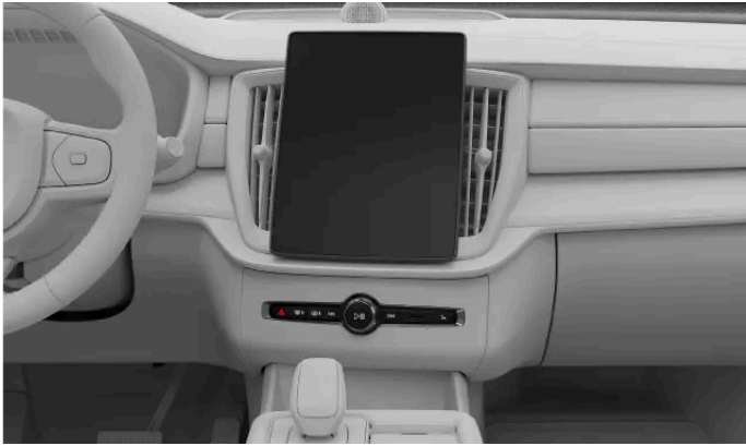
Pulsanti nel display centrale e dello sbrinatori sulla plancia di comando sotto il display centrale
