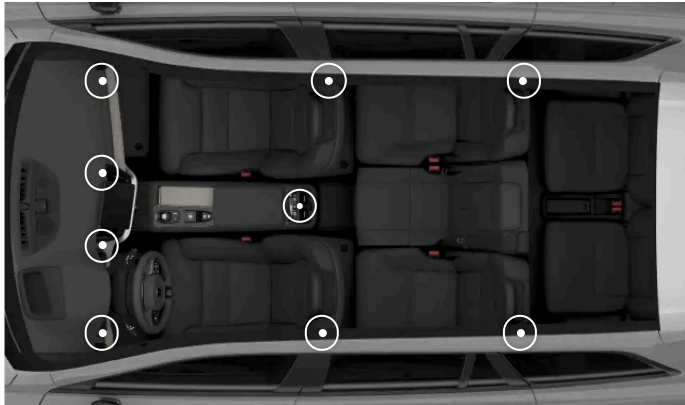
Posizione delle bocchette di ventilazione regolabili
