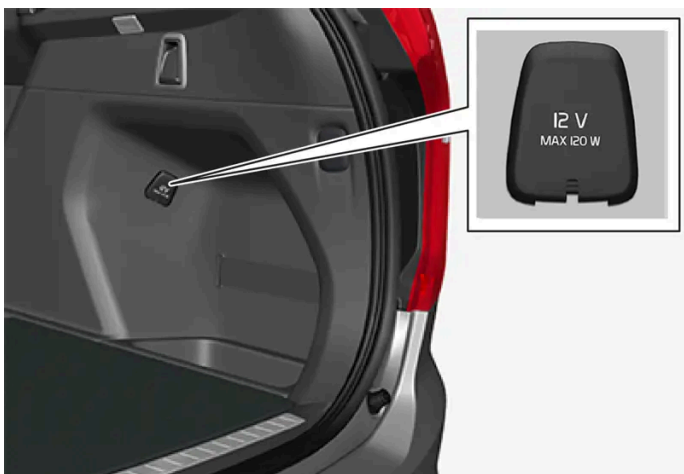
Presa elettrica da 12 V nel bagagliaio*.
