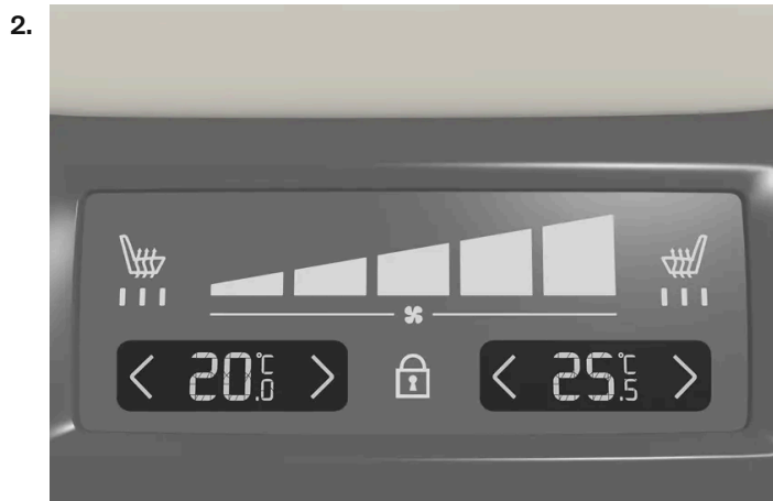
Comandi di temperatura sul pannello del climatizzatore sul retro del tunnel.
