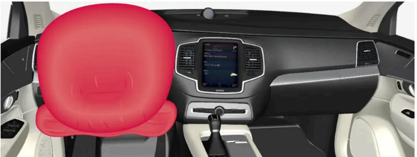
Airbag nel volante e airbag ginocchia nel sedile anteriore sul lato conducente.
