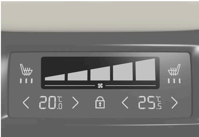
Comandi della ventola sul pannello del climatizzatore sul retro del tunnel.
