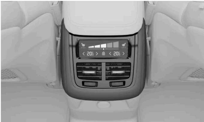
Comandi del climatizzatore nel tunnel centrale
