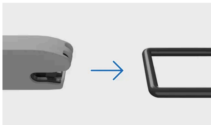
Fissare l'attacco ISOFIX nel punto di fissaggio
