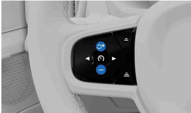
Regola la velocità di riferimento usando i pulsanti sul volante.
