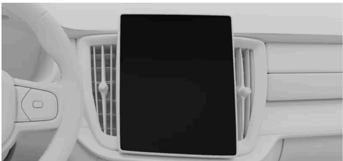
Il display centrale si trova al centro del cruscotto e si attiva automaticamente quando si apre la porta del conducente.
