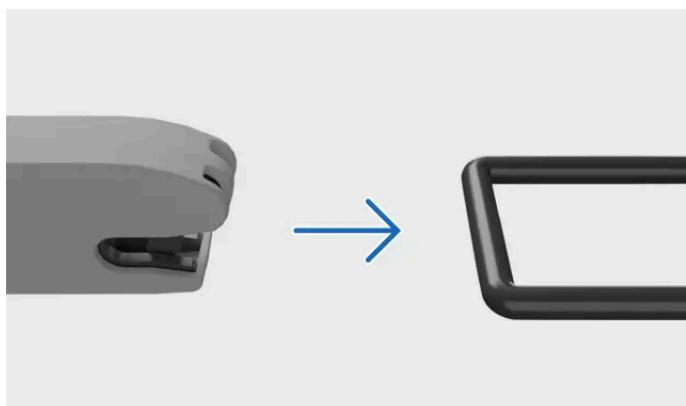
Fissare l'attacco ISOFIX nel punto di fissaggio
