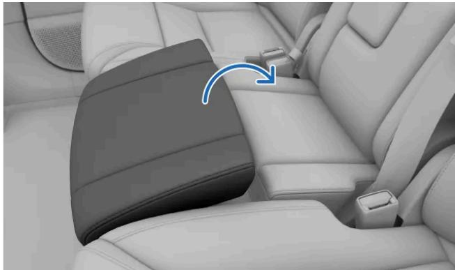
Con una mano sulla parte anteriore del seggiolino per bambini e una sulla parte posteriore, solleva il seggiolino e spingilo all'indietro fino allo schienale del sedile.
