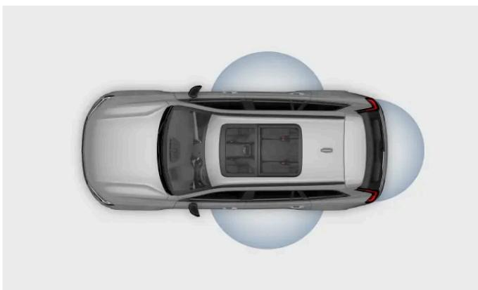
I pulsanti della chiave standard hanno un raggio di rilevamento lungo. Se la tua auto non reagisce alla pressione di un pulsante, prova ad avvicinarti.
