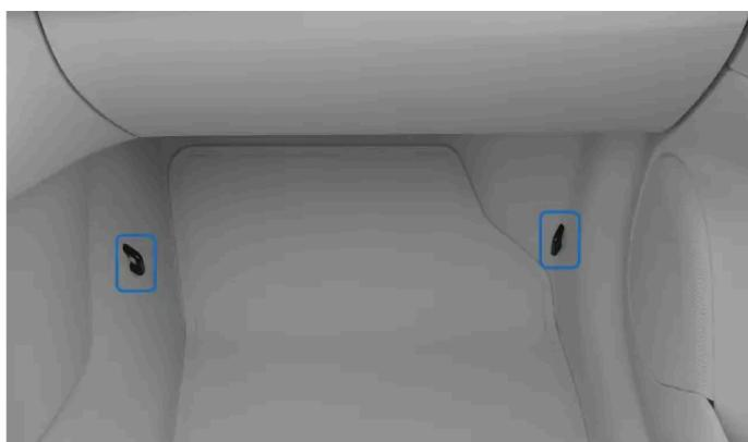
I punti di fissaggio della cinghia inferiori del sedile del passeggero anteriore si trovano ai lati del vano piedi del sedile.
