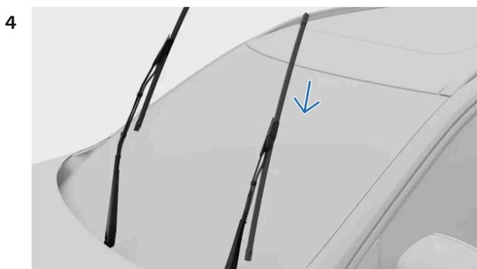
La spazzola del lato conducente deve essere più lunga di quella del lato passeggero. Fai scorrere la spazzola tergilustro sul braccio del tergilustro. Controlla che il perno del braccio del tergilustro entri nel foro della spazzola. Spingi la spazzola nel braccio del tergilustro finché non senti un clic.
