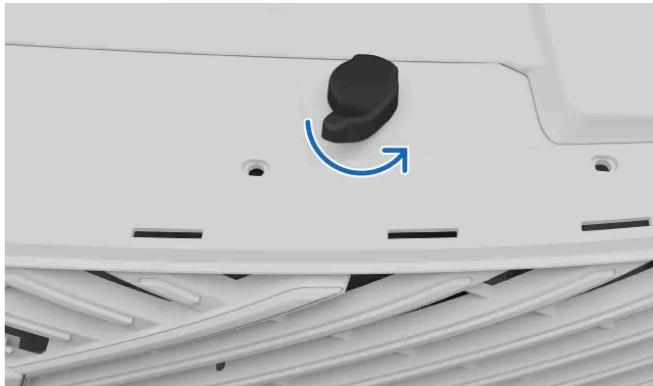
Individua la seconda leva sotto il bordo anteriore del cofano e ruotala in senso antiorario.
