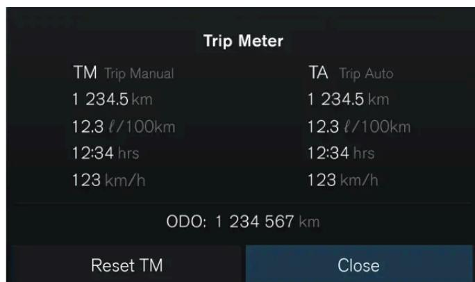
La tua auto è provvista di un contachilometri parziale e di un contachilometri. Il contachilometri parziale può mostrarti informazioni sulla distanza e sul tempo di guida della tua auto, oltre al consumo medio di carburante e alla velocità di guida.
