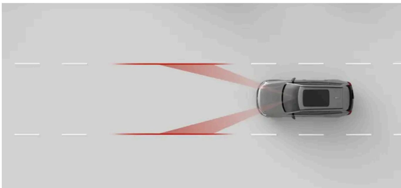
Quando il sistema di mantenimento della corsia è attivo, l'auto può avvisarti se stai per uscire dalla tua corsia di marcia e può chiederti di guidare con attenzione. Può anche intervenire sullo sterzo. Il sistema di mantenimento della corsia si basa sulla telecamera anteriore dell'auto per identificare la segnaletica stradale e la tua posizione nella corsia.
