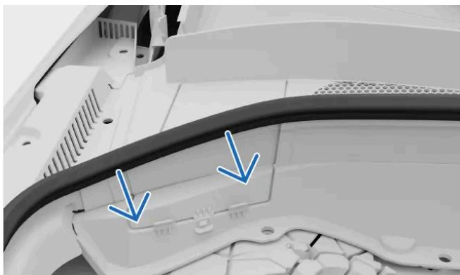
Il contenitore del liquido di raffreddamento si trova nell'angolo superiore sinistro del vano motore, sotto il portellone di un pannello. Tira la guarnizione di gomma verso il vano motore per accedere al portellone.
