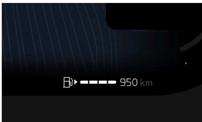
La tua autonomia dipende principalmente dalla quantità di carburante rimasto nella tua auto e dal tuo stile di guida, ma anche le condizioni esterne possono influire. L'indicatore del livello di carburante e l'autonomia prevista sono visualizzati nel display del conducente.
