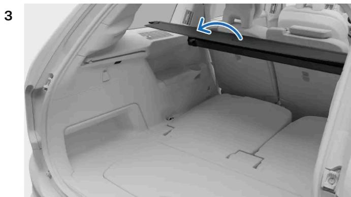
Estrarre la schermata del pianale tramite la maniglia sopra i pannelli laterali del bagagliaio.
