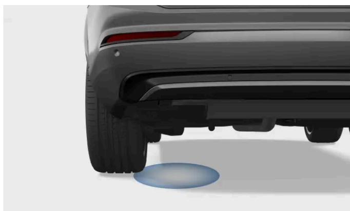
Il sensore rileva il movimento sotto il paraurti posteriore. Qualsiasi movimento rilevato sblocca il bagagliaio.
