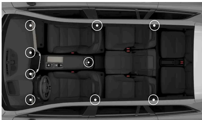
Posizione delle bocchette di ventilazione regolabili
