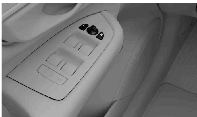
Comandi per la regolazione degli specchietti laterali
