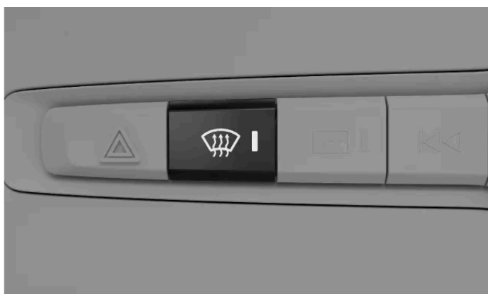
Pulsante dello sbrinatori massimo sulla plancia di comando sotto il display centrale
