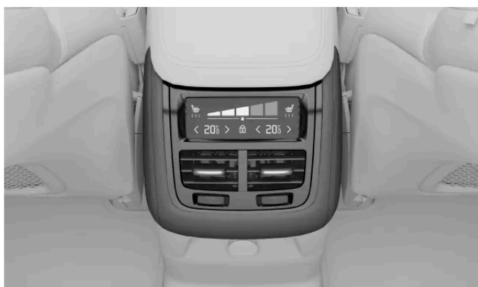
Comandi del climatizzatore nel tunnel centrale
