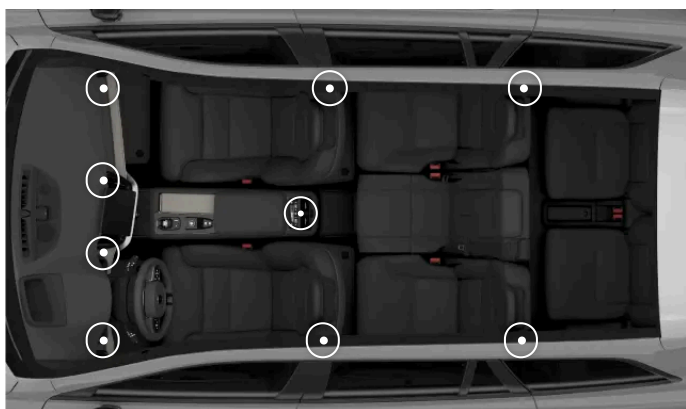
Posizione delle bocchette di ventilazione regolabili
