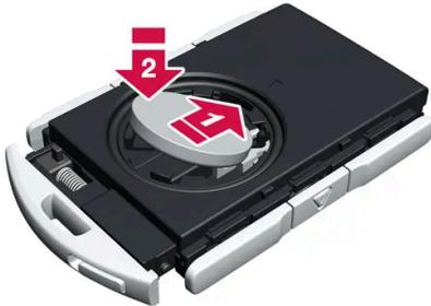
새 배터리를 (+) 쪽을 위로 오게 하여 장착합니다. 키의 배터리 접점을 손가락으로 만지지 마십시오.
