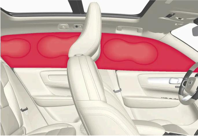
커튼 에어백은 헤드라이닝의 양 측면을 따라 장착되어 있으며 운전자와 차량의 좌측 탑승자를 보호하는 데 도움을 줍니다. 패널에 IC AIRBAG이라는 라벨이 부착되어 있습니다.
