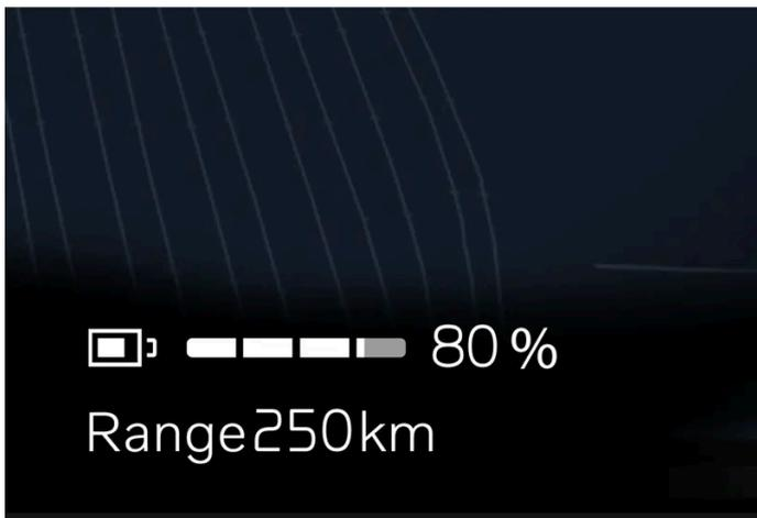
운전자 화면 하단에 있는 배터리 게이지는 고전압 배터리 충전 상태(SoC)를 표시합니다. 이것은 남은 주행 가능 거리가 50 km(30 마일) 미만일 때 배터리 게이지 옆에 표시됩니다. 주행 가능 거리는 운전 스타일 및 온도와 같은 요소의 영향을 받을 수 있습니다.
