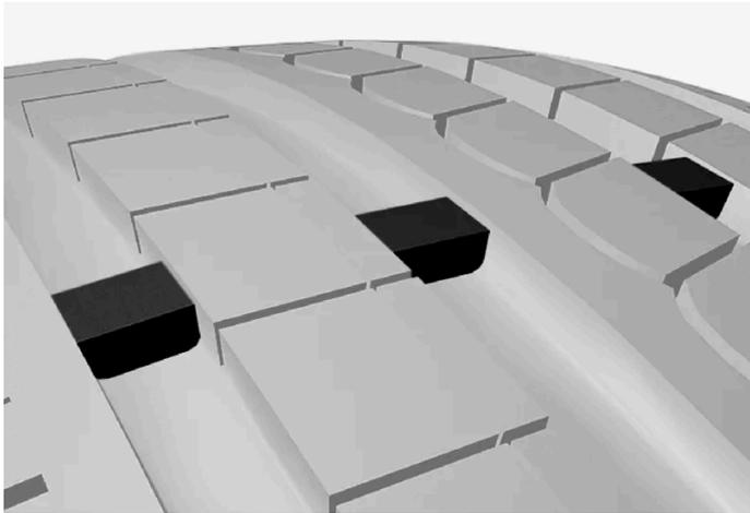
트레드 마모 표시는 타이어의 트레드 패턴의 세로 홈을 따라 있는 좁은 용기부입니다. 타이어 측면에는 TWI (Tread Wear Indicator)라는 글자가 있습니다. 타이어의 트레드 깊이가 **1.6 mm(1/16 인치)**가 되면, 트레드 높이가 트레드 마모 표시와 동일해집니다. 최대한 빨리 새 타이어로 교환하십시오. 트레드 깊이가 얼마 남지 않은 타이어는 빗길과 눈길에서 매우 낮은 접지력을 제공합니다.
