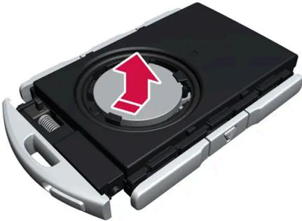
배터리 + 쪽은 위를 향하고 있습니다. 가장자리를 눌러 배터리를 헐겁게 한 후 들어 올려 빼냅니다.
