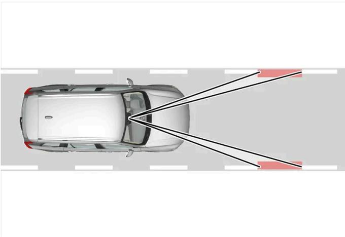
운전자 경고 시스템(Driver Alert)은 차선 내의 차량 위치를 읽습니다.
