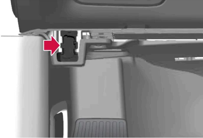
데이터 링크 커넥터(On-board Diagnostic, OBDII)는 운전석 측의 계기 패널 아래에 있습니다.
