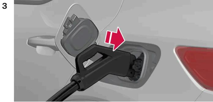
충전 케이블을 두 손으로 잡고 차량의 충전 입력 소켓 안쪽으로 충전 케이블을 끝까지 누릅니다. 충전 손잡이를 몇 초간 위쪽으로 유지합니다. 2-3초 후에 충전 케이블이 충전 입력 소켓에 자동으로 잠깁니다. 충전이 시작될 수 있도록 충전 케이블이 올바르게 잠겼는지 확인합니다.
