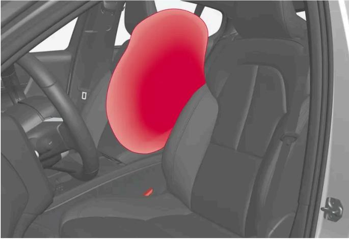
파-사이드 에어백은 앞좌석 내측 등받이 프레임에 장착되어 있으며 운전석 및 동승석 탑승자를 보호하는 데 도움을 줍니다. 시트에 AIRBAG 이 표시되어 있습니다.
