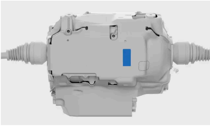
뒤쪽 전기 모터의 일련 번호 및 모델 표시 위치
