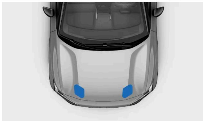
보닛 뚜껑의 앞쪽 가장자리를 양손으로 누르세요. 동시에 보닛이 잠금장치에 제대로 고정되는지 확인하세요. 닫을 때 앞쪽 가장자리를 평평하게 유지하세요.
