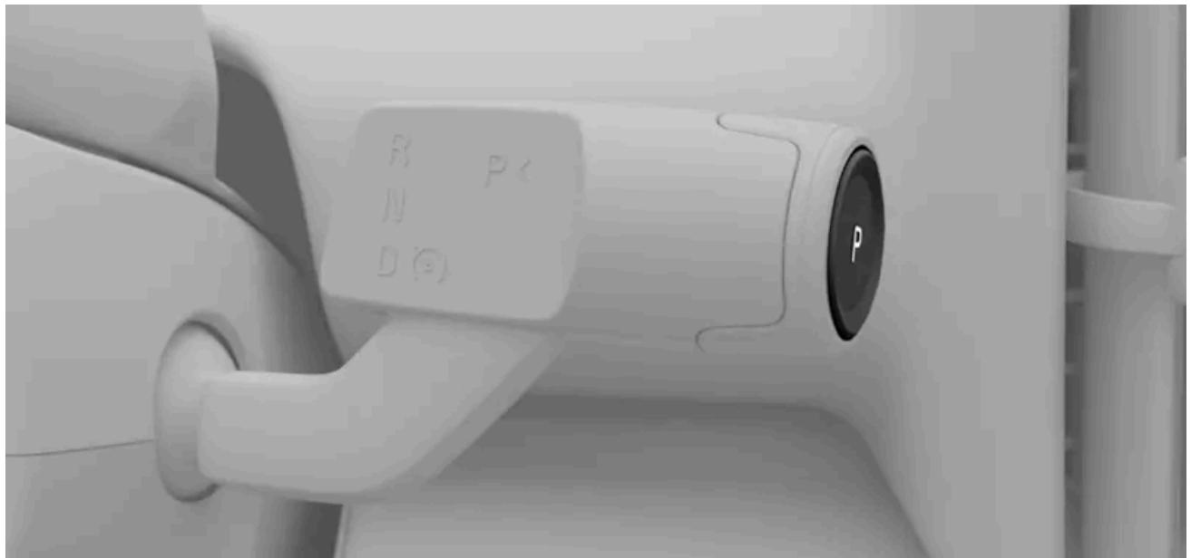
▶ 차량이 주차 상태로 전환하고 여기에는 주차 브레이크 체결이 포함됩니다. 새 상태가 운전자 정보 영역에 표시됩니다.
