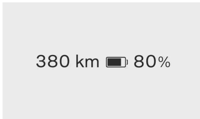
게이지는 항상 운전자 정보 영역에 표시됩니다. 배터리 아이콘의 색깔은 배터리의 충전 잔량에 따라 변경됩니다.
