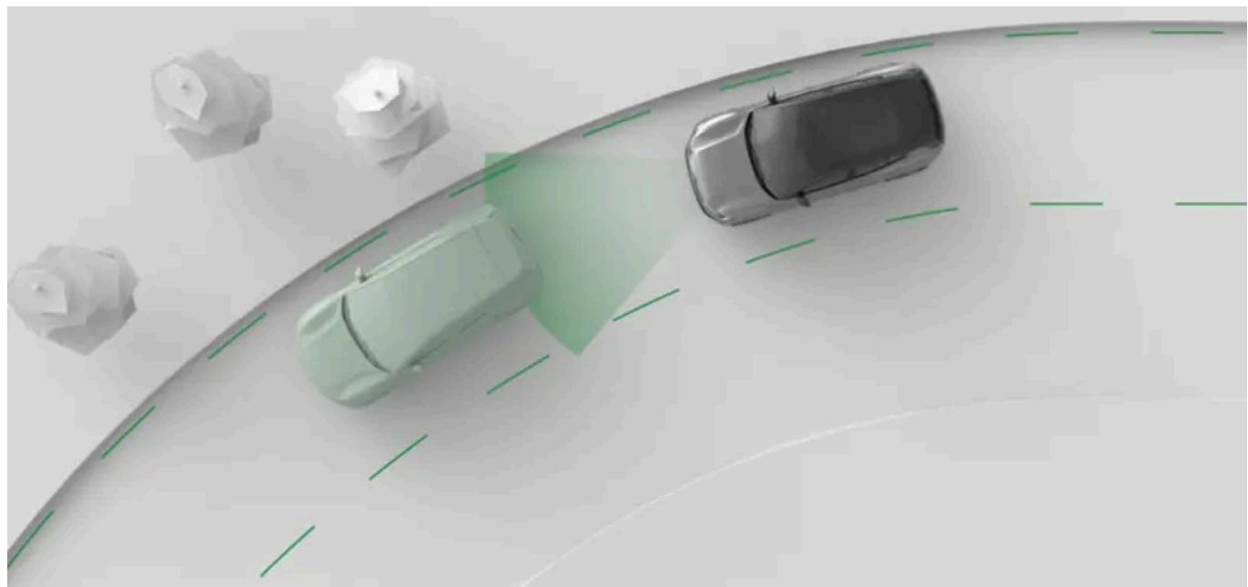
Pilot Assist는 다양한 방식으로 주행을 능동적으로 안내합니다. Pilot Assist로 주행할 때 운전자는 목표 속도를 선택합니다. 그러면 차량이 가속과 제동을 관리하여 목표 속도를 달성하는 동시에 주변 교통 상황에 적응합니다.
