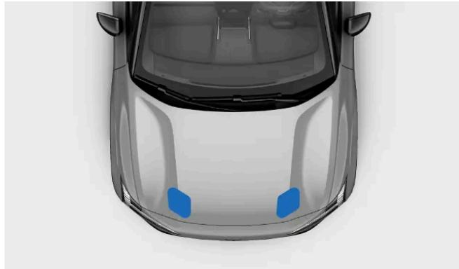
보닛 뚜껑의 앞쪽 가장자리를 양손으로 누르세요. 동시에 보닛이 잠금장치에 제대로 고정되는지 확인하세요. 닫을 때 앞쪽 가장자리를 평평하게 유지하세요.
