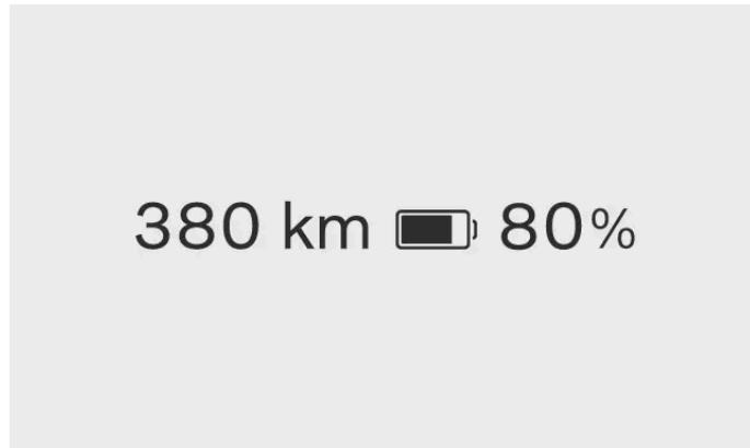
주행 가능 거리는 주로 차량의 배터리 잔량 및 운전 습관과 관련이 있지만 외부 조건도 요인이 될 수 있습니다. 배터리 잔량과 예상 주행 가능 거리는 운전자 정보 영역에 표시됩니다. 예상 주행 가능 거리는 현재 배터리 잔량으로 주행할 수 있는 거리를 알려줍니다. 예상 주행 가능 거리는 현재 및 과거 주행 패턴과 실시간 주행 조건에 따라 계산됩니다.
