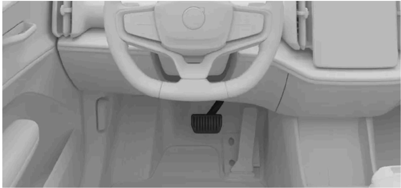
풋 브레이크는 페달을 얼마나 세게 밟는지에 따라 회생 제동 또는 마찰 브레이크를 작동합니다. 가볍게 제동하면 회생 제동이 켜지고, 강하게 제동하면 마찰 브레이크가 작동합니다.
