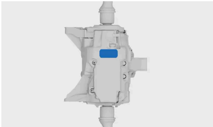
전방 전기 모터의 유형 코드 및 일련 번호의 위치.
