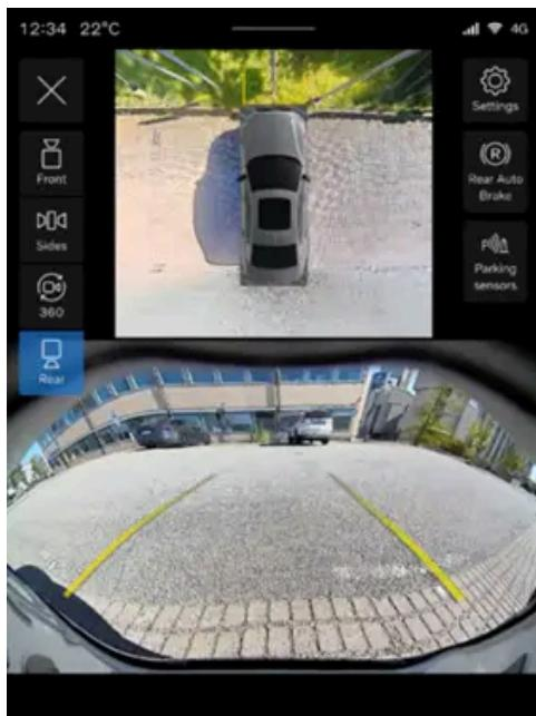
주차 보기는 두 가지 보기를 동시에 표시할 수 있습니다. 이미지는 중앙 화면의 하단 절반부에 표시되는 후방 카메라 보기를 선택한 후에 표시되는 화면의 예를 보여 줍니다. 화면의 상단 절반부에는 차량 주변이 표시됩니다.
