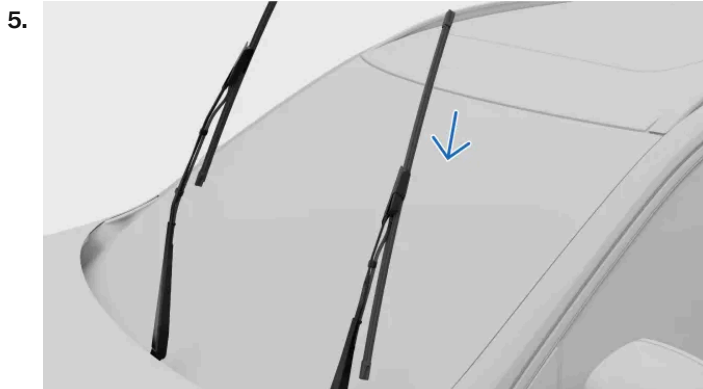
운전석 측 블레이드가 동승석 측 블레이드보다 길다는 점에 유의하세요. 와이퍼 블레이드를 와이퍼 암 위에 밀어 넣으세요. 와이퍼 암의 핀이 와이퍼 블레이드의 구멍에 들어가는지 확인하세요. 딸깍 소리가 날 때까지 블레이드를 와이퍼 암에 밀어 넣으세요.
