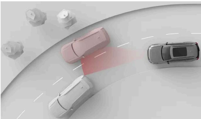
커브길에서 앞차가 감지 영역을 벗어날 수 있습니다. 인접 차선의 차량도 감지 영역에 진입하여 차량이 전방 차량과의 거리를 인식하는 데 영향을 줄 수 있습니다.
