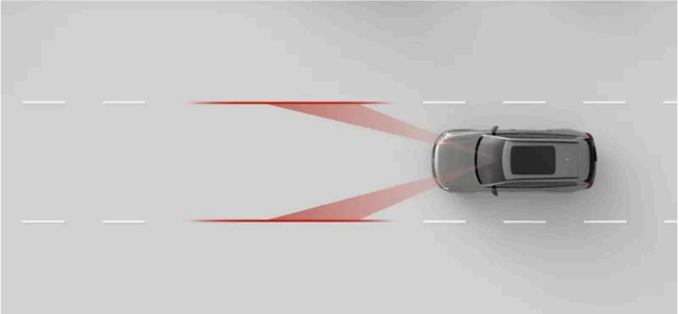
차선 유지 보조장치를 활성화하면, 차선을 벗어나려고 할 때 차량이 운전자에게 경고하고 주의를 기울여 차량을 조향하도록 요청할 수 있습니다. 조향 개입도 수행할 수 있습니다. 차선 유지 보조장치는 차량의 전방 카메라를 사용하여 노면 표시와 차선 내의 차량 위치를 식별합니다.
