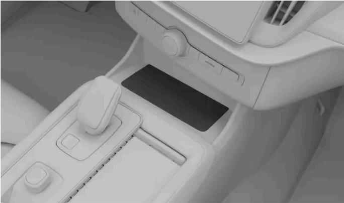
무선 충전기를 사용하려면 장치가 Qi 무선 충전 표준 인증을 받아야 합니다. 또한 장치<sup>[1]</sup>(대부분의 Qi 호환 장치는 항상 켜져 있음)와 충전기 자체에서 모두 무선 충전이 켜져 있는지 확인하세요. 중앙 화면에서 충전기를 켤 수 있습니다.
