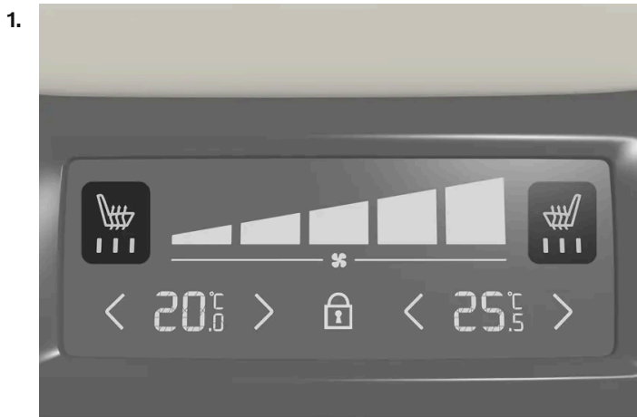
터널 콘솔 뒤쪽의 온도 조절 패널의 시트 열선 표시등 및 컨트롤.
