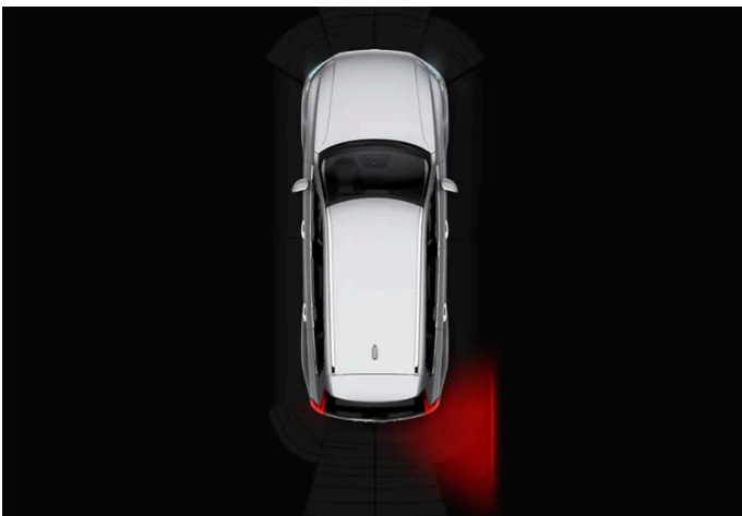
화면의 주차 보조 시스템 그래픽에 있는 Cross Traffic Alert용 점등된 아이콘.
