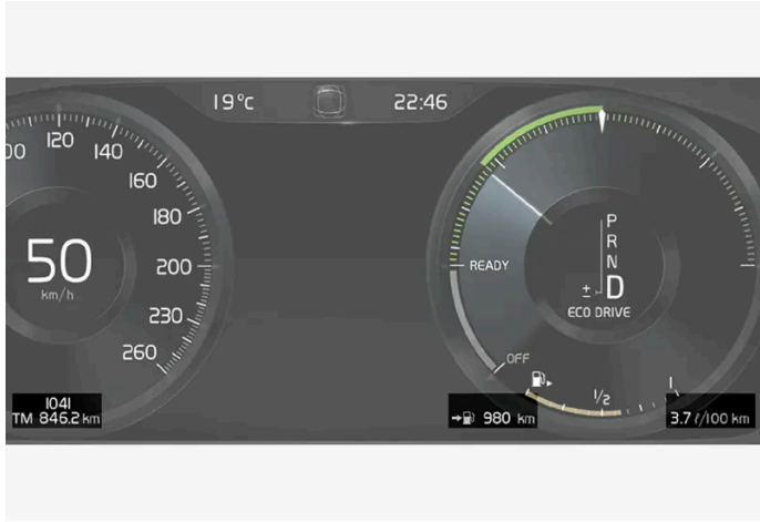
12인치 운전자 화면* 트립 컴퓨터 정보의 예, 그림은 참고용이며 차량 모델에 따라 부분이 다를 수 있습니다.
