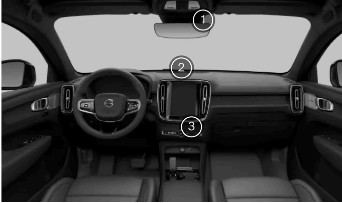
Capteurs intérieurs de climatisation
