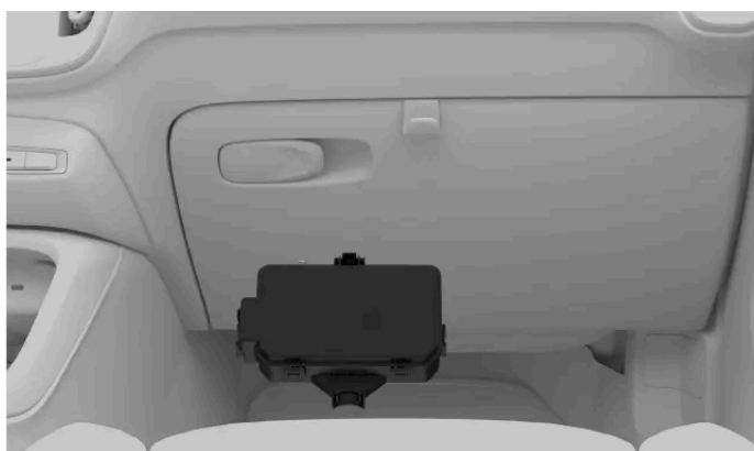
Emplacement de la boîte à fusibles
