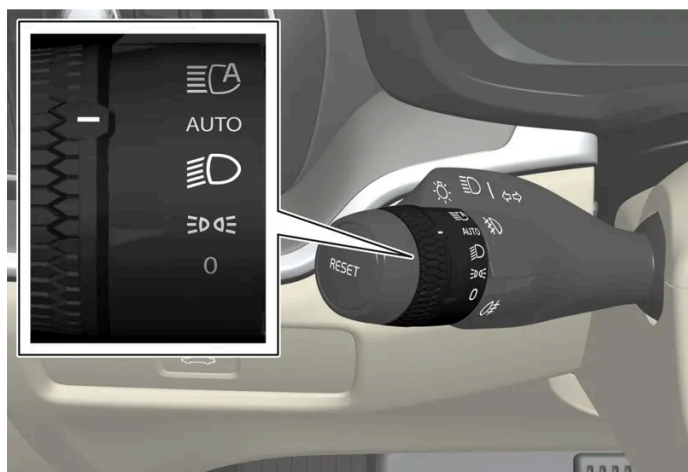
Molette du levier gauche au volant
