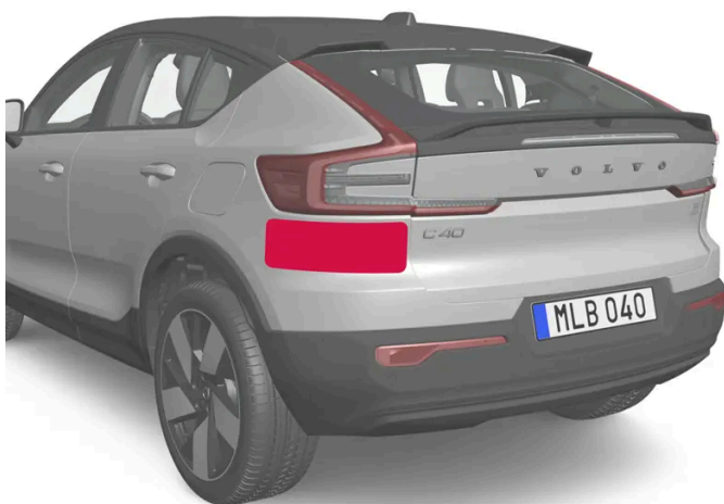
Position des unités radar arrière
