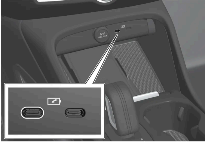
Ports USB (type C), siège avant
