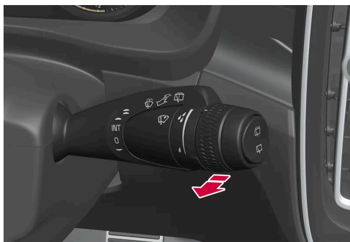
Fonction lave-glace, levier droit au volant
