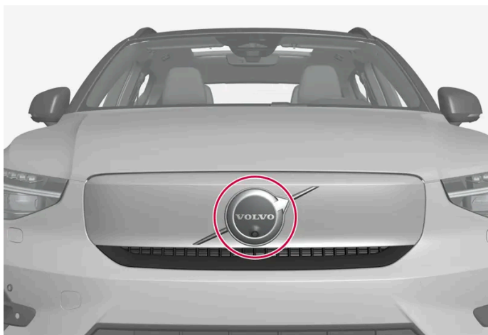
Position de l'unité radar avant
