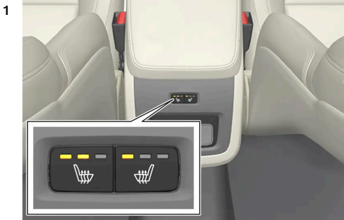
Boutons des sièges arrière chauffants sur la console de tunnel.
