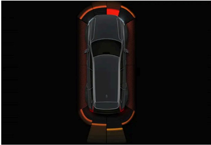
Exemple de vue à l'écran avec zones de non détection et secteurs de capteurs
