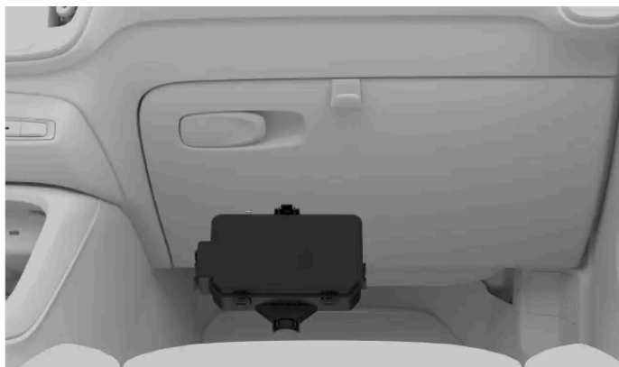
Emplacement de la boîte à fusibles
