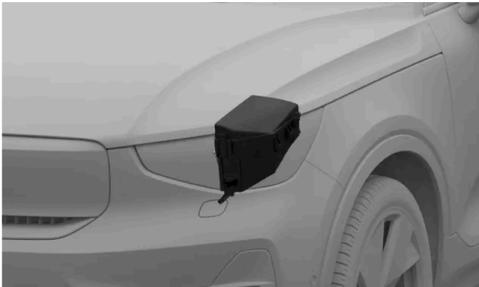
Emplacement de la boîte à fusibles
