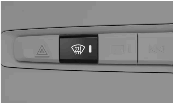
Bouton de dégivrage maximal sur le panneau de boutons en dessous de l'écran central
