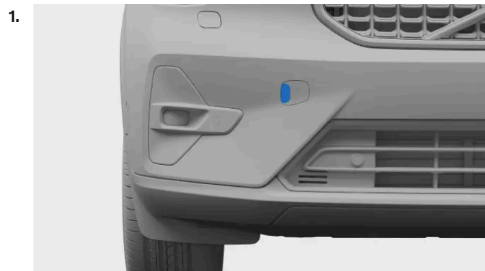
Cache de fixation d'anneau de remorquage avant
