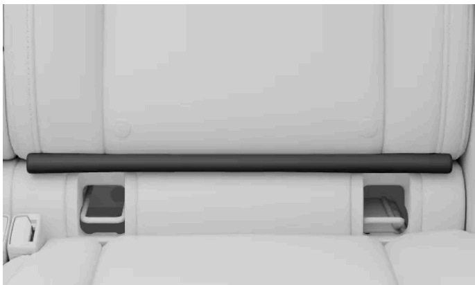
Rabat ISOFIX replié dans l'espace situé au-dessus des points de fixation
