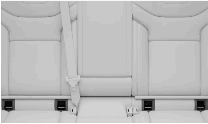
Position des points de fixation ISOFIX pour les sièges arrière
