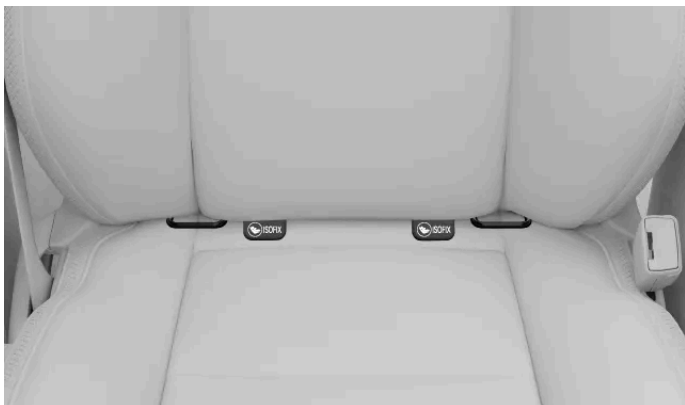
Position des points de fixation ISOFIX pour le siège passager avant
