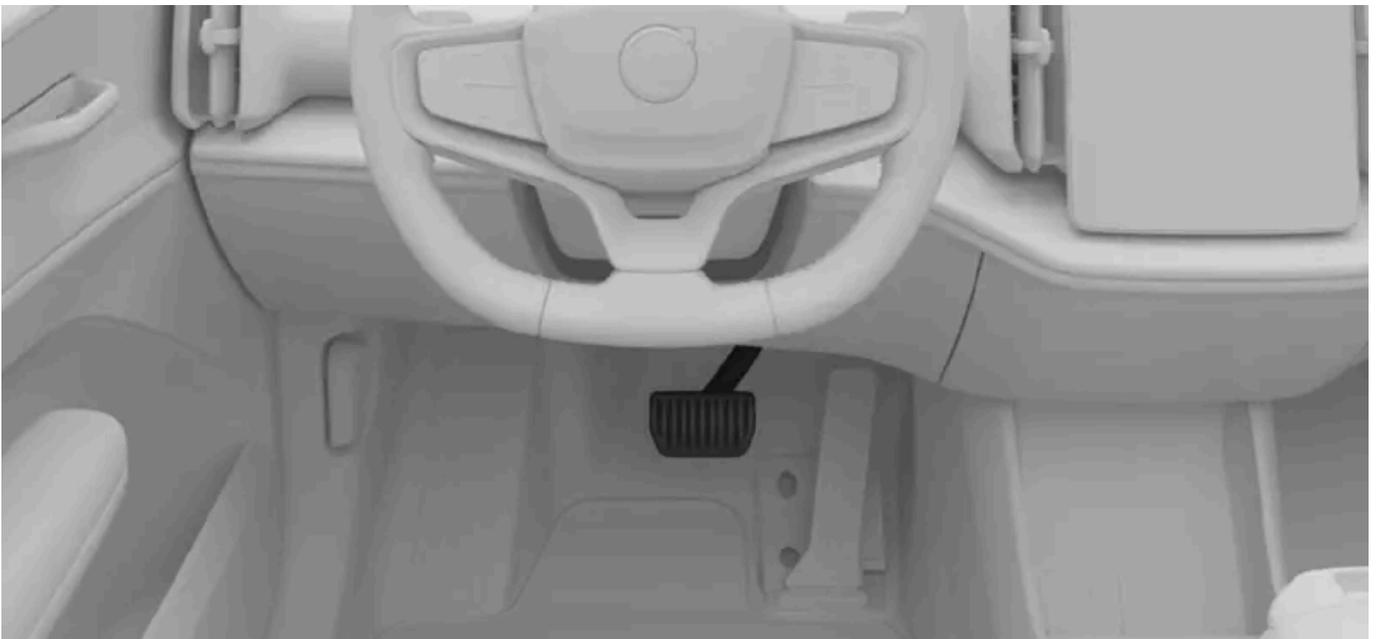
Le frein à pied déclenche le freinage régénératif ou les freins à friction selon la pression que vous appliquez à la pédale. Un freinage léger active le freinage régénératif, tandis qu'un freinage plus appuyé actionne les freins à friction.
