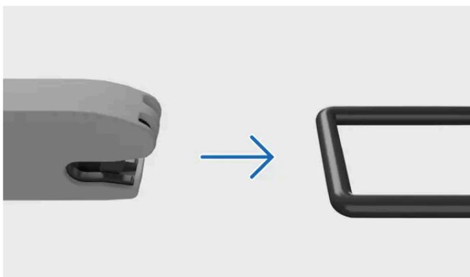
Les sièges enfant installés sur les sièges arrière extérieurs peuvent utiliser ces points de fixation.
