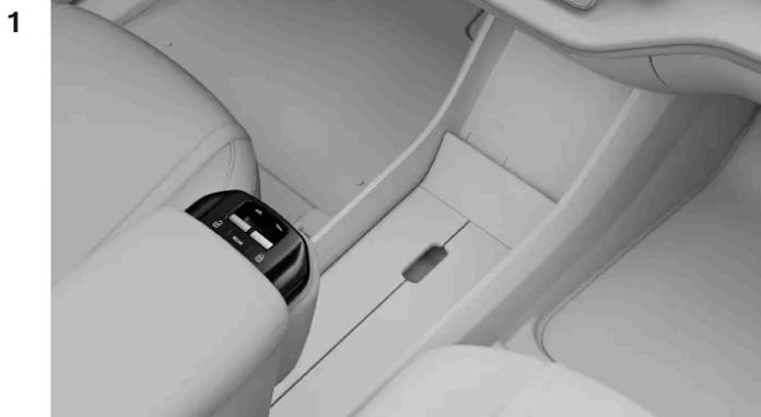
Vous pouvez commander toutes les vitres électriques depuis le siège avant. Appuyez sur le bouton portant la mention REAR pour alterner l'actionnement des vitres avant et arrière. Le bouton prend la couleur ambre pour indiquer que les vitres arrière sont sélectionnées. Les commandes repassent aux vitres avant si vous appuyez à nouveau sur le bouton ou au bout de quelques secondes d'inactivité.
