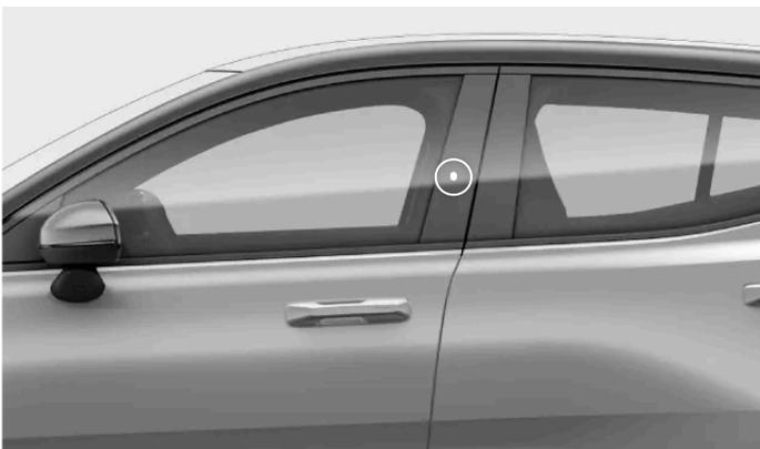
Zone de détection de clé sur le montant de porte
