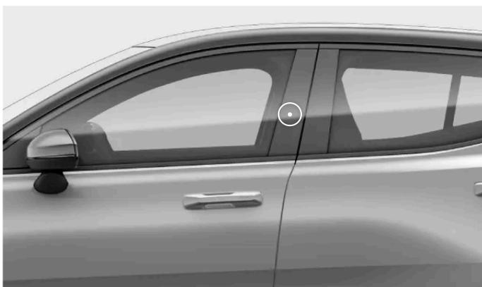
Zone de détection de clé sur le montant de porte conducteur
