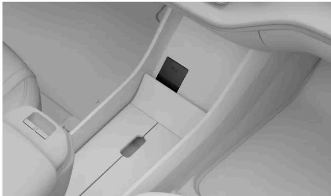
Position du lecteur de cartes-clés utilisé pour démarrer la voiture avec une carte-clé ou avec une clé à fonction de commande à distance déchargée
