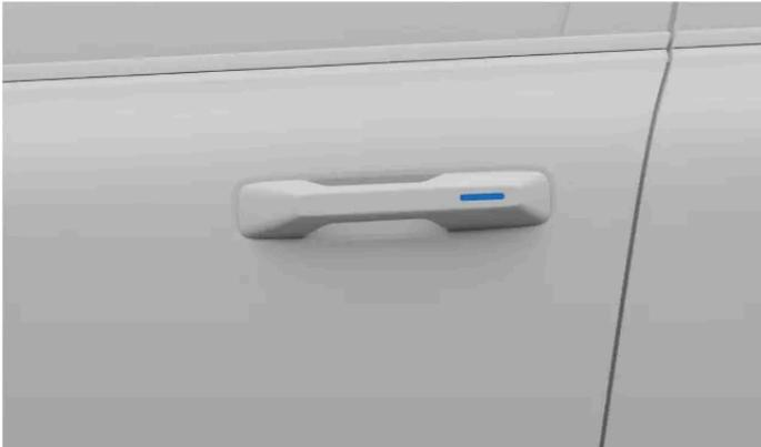
Le renforcement marque l'endroit où vous pouvez placer le pouce ou les doigts pour verrouiller la porte.
