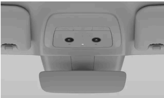
Liseuses des sièges avant dans la console au plafond
