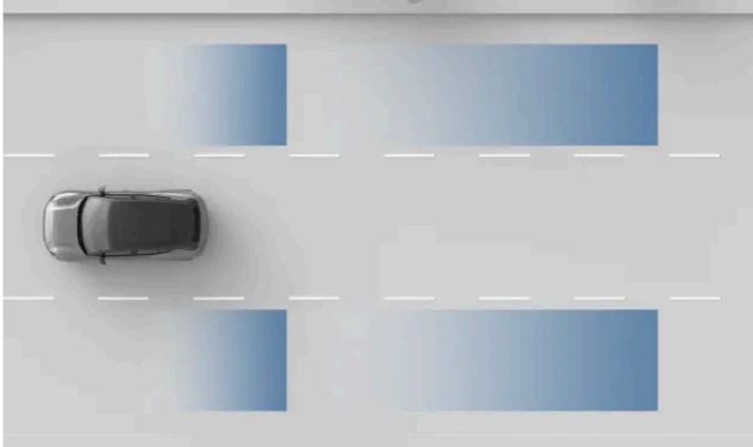
Zones de détection de radar
