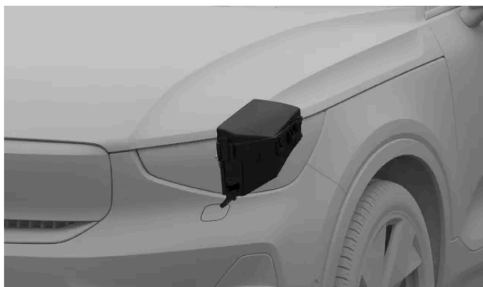
Emplacement de la boîte à fusibles
