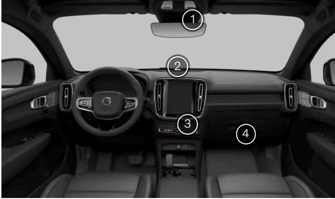
Capteurs intérieurs de climatisation
