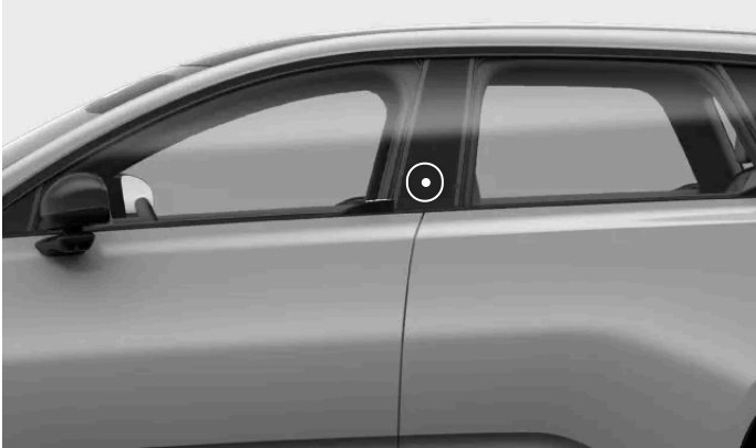
Emplacement du lecteur de clé sur le montant de porte
