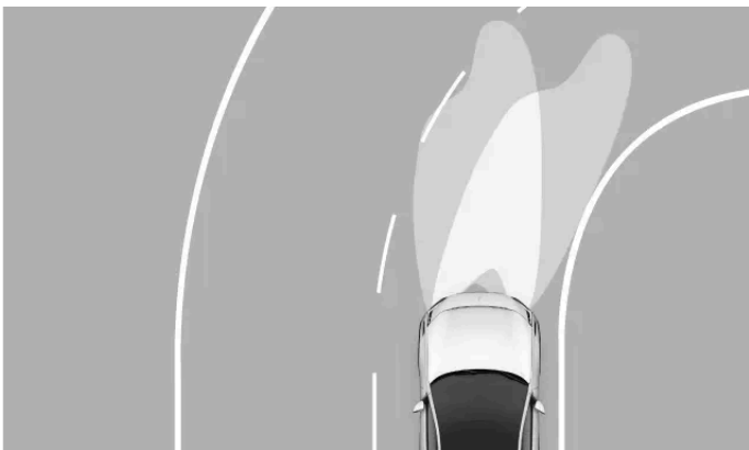
Cas typique d'opération des phares actifs en virage
