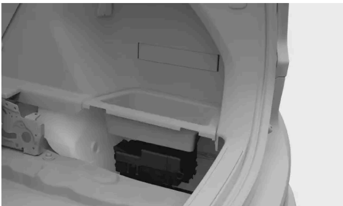
Emplacement de la boîte à fusibles
