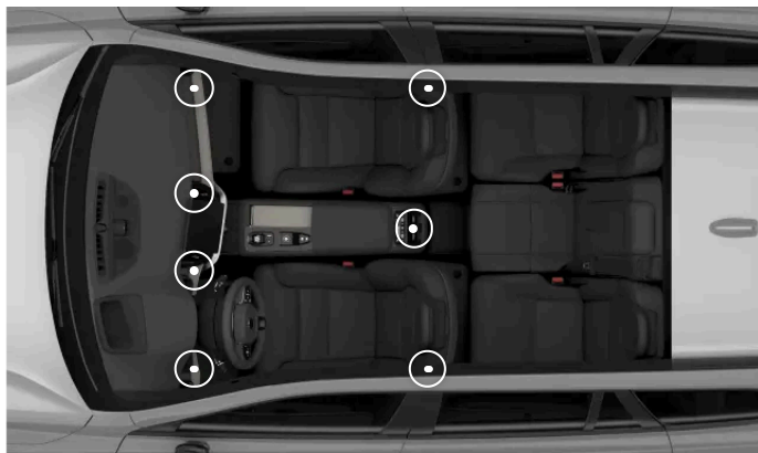
Position des buses de ventilation réglables
