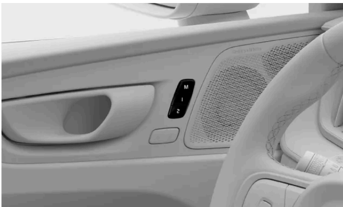
Emplacement des boutons de préréglages de siège
