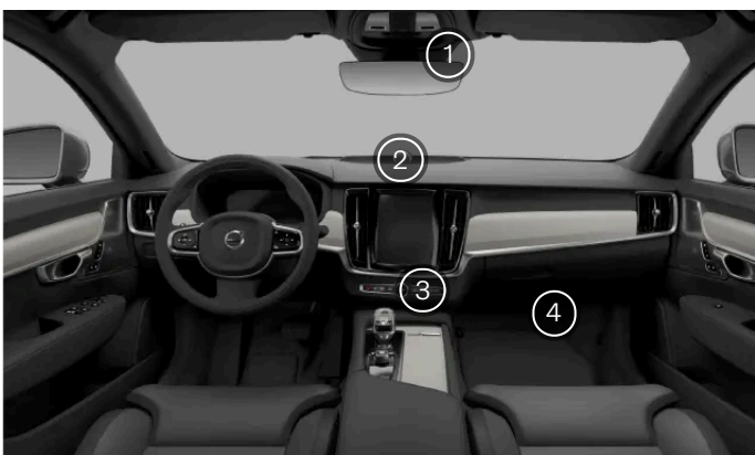
Capteurs intérieurs de climatisation
