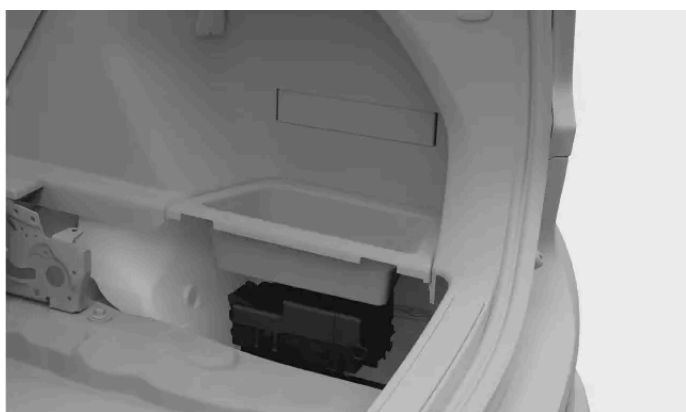
Emplacement de la boîte à fusibles
