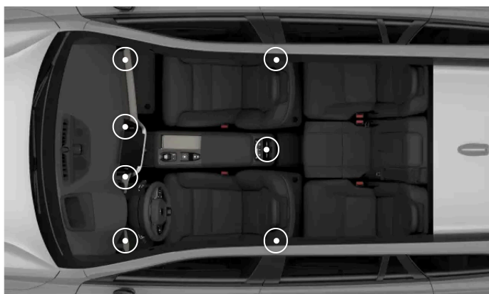
Position des buses de ventilation réglables
