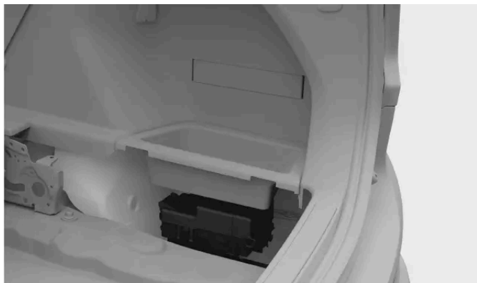
Emplacement de la boîte à fusibles
