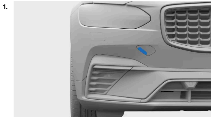
Cache de fixation d'anneau de remorquage avant
