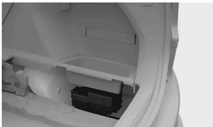
Emplacement de la boîte à fusibles
