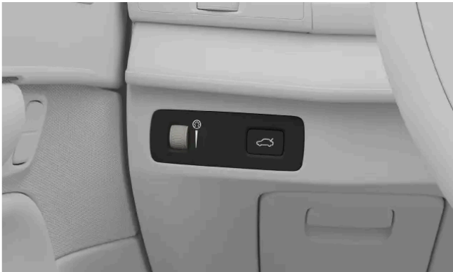
La molette de réglage de l'éclairage intérieur
