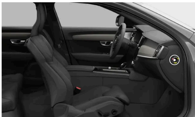
Position de l'interrupteur de coussin gonflable passager
