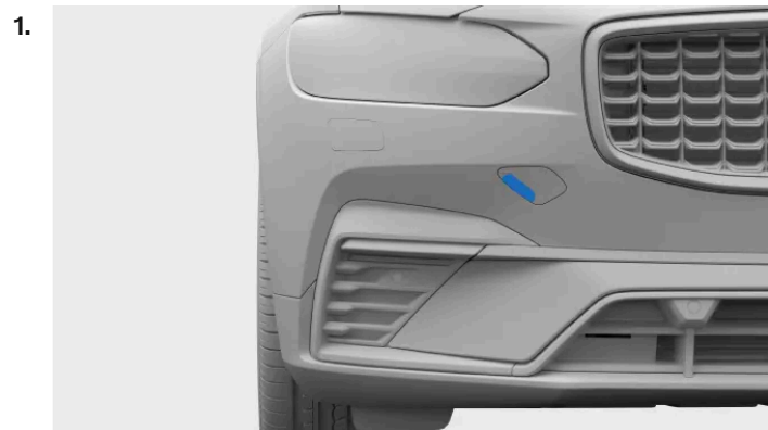
Cache de fixation d'anneau de remorquage avant
