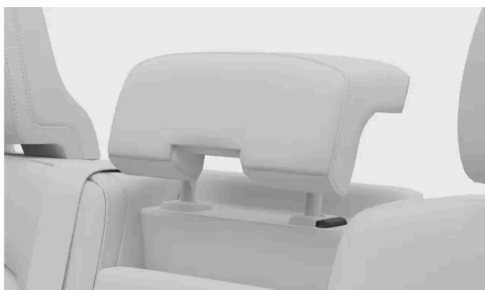
Bouton de verrouillage sur l'appui-tête
