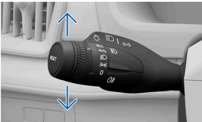
Clignotants sur le levier au volant gauche
