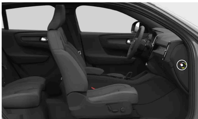
Position de l'interrupteur de coussin gonflable passager
